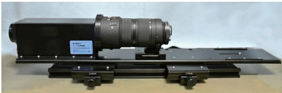
本装置は、レンズを近づけることができない 100mm から 300mm 程度離れた条件で、かつ被写体が 10mm~1mm 程度の小さいものを拡大撮影したい要求に応えるための光学装置です。本装置は、ズーム光学部とリレーユニット部から成り立っています。リレーユニット部の先端レンズ（対物レンズ）は 3 種類ありこのレンズで装置の作動距離が決まります。ズーム光学部は拡大レンズとズームレンズで成り立っています。総合倍率は、対物レンズと拡大レンズの組み合わせで決まります。
