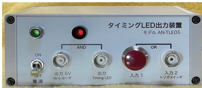
本装置は、高速度カメラや産業用のカメラでトリガー信号をカメラに入力できない場合に、タイミング LED を発光させて撮影画像に写し込み、同時に TTL 規格の (5V 立ち上がりパルス) を出力させ集録装置に保存させるものです。熱電対や、歪みゲージ、加速度センサーのデータをカメラ撮影映像と同時に取り込む場合、時間軸を合わせる必要があります。そうした应用到本装置は使われます。
