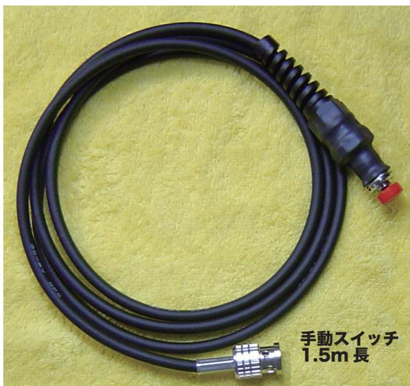
トリガスイッチケーブルは、計測カメラや高速度カメラに使う、手動トリガのためのスイッチです。
