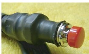
計測カメラの多くは、内部のトリガ回路に、TTL (Transistor-Transistor Logic) や CMOS 回路の 3.3V~5.0V を使っていて、扱う電流も、1~10mA 程度です。トリガケーブルの長さは、本体で 1.5m あり、必要に応じて BNC-BNC 中継プラグで延長することができます。20mまで
