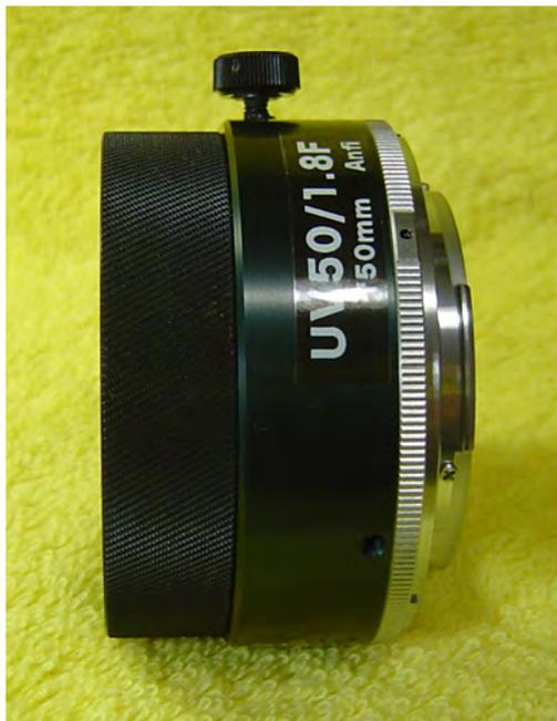
本製品は、紫外領域に感度を持つカメラレンズです。レンズ材質に合成石英を使っており、透過感度波長は、200nm～1,000nmです。
