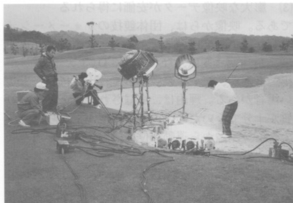
図4 ゴルフインパクトハイスピードカメラ撮影風景 (10,000コマ/秒)
