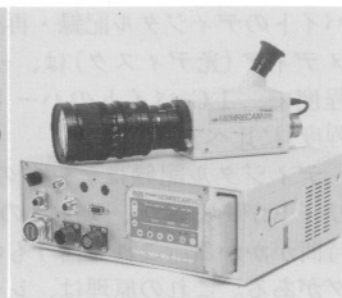
図8 データ圧縮技術を用いた高速度カラーデジタルカメラ ナック MEMRECAM C2S
