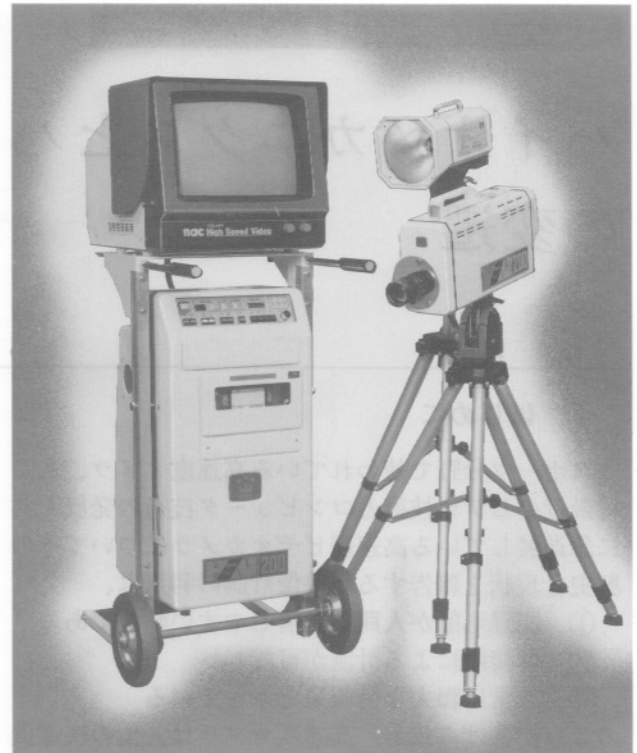
図2 VHS方式カラーハイスピードビデオ ナック HSV-200
