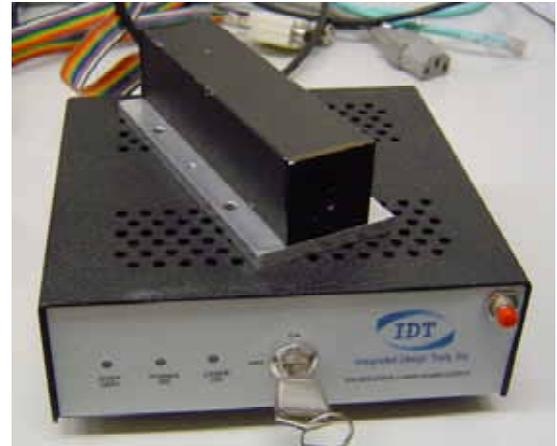
3. PIV 光源 (半導体レーザー、YAG レーザ) を用意する。
