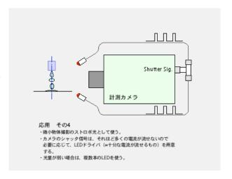
右の図は、BNC 端子で処理 した 2 つの LED ケーブルを T-BNCで並列接続したもので す。TTL 信号でも十分に発光 します。
