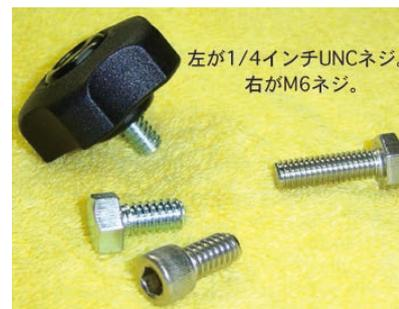
カメラネジは、1/4UNC-20 という米国の規格品番です。(日本の JIS 規格ではカメラネジとして特殊使用で認められています。) ホームセンターで六角ボルトか六角穴付ボルトを容易に買い求めることができるので、三脚を使わずに実験装置に固定したり車載で使う際にはこのネジを用品です。カメラネジの他にユーティリティネジ (インチネジ) が装備されていますので、必要に応じてカメラプレートなどを製作します。
