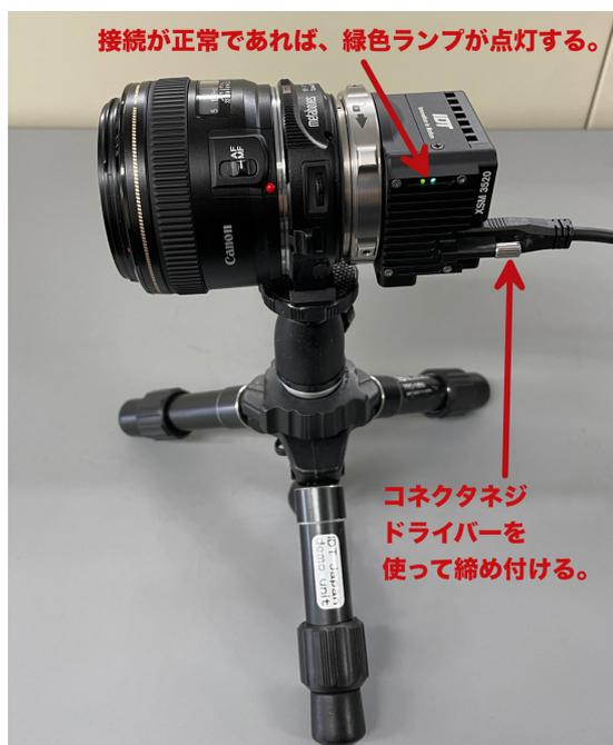
XSM カメラ用ケーブルは、専用ロックネジ付の USB-C ケーブルを用います。
